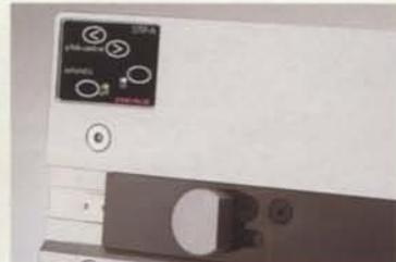
Alimentador con sensor que dispara el proceso de troquelado
