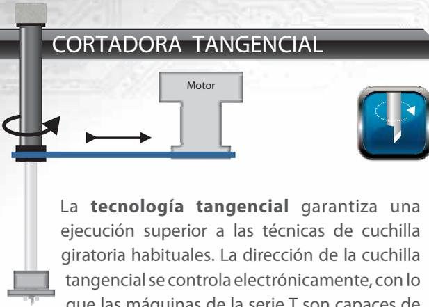
La **tecnología tangencial** garantiza una ejecución superior a las técnicas de cuchilla giratoria habituales. La dirección de la cuchilla tangencial se controla electrónicamente, con lo que las máquinas de la serie T son capaces de cortar de forma muy precisa a presiones muy altas. El corte perfecto hace que el pelado sea muy sencillo, ahorrándole un valioso tiempo.
